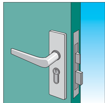
Insteekslot met veiligheidsbeslag in stompe deur
